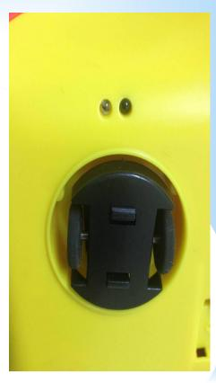
走動功能可以透過按鍵/語音控制/APPS遙控的方式啟動, 我們的方案設有IR的功能, 可以感應及避開障礙
